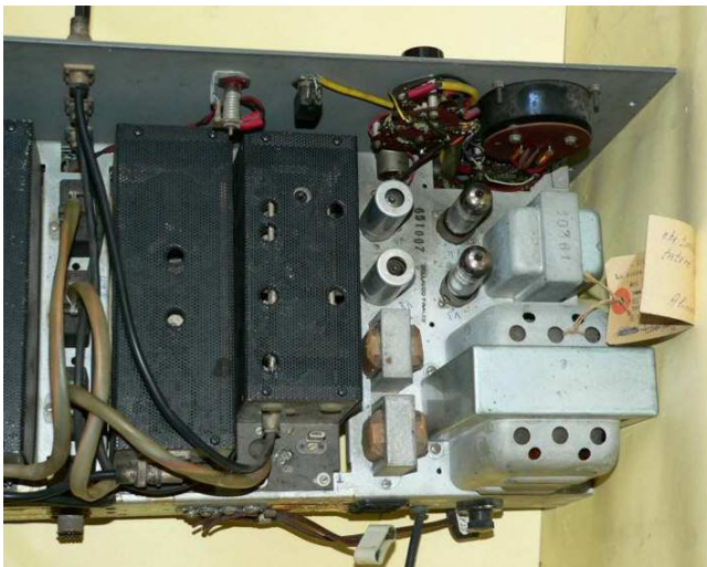
G4/172 prototipo alimentatore visto da sopra Particolare commutatore e strumento di misura
