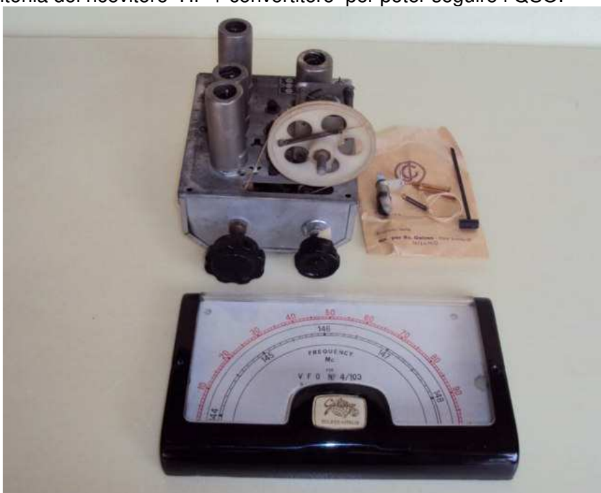
KIT Geloso per la realizzazione di un TX per 144-148 MHz .con gruppo 4/103
