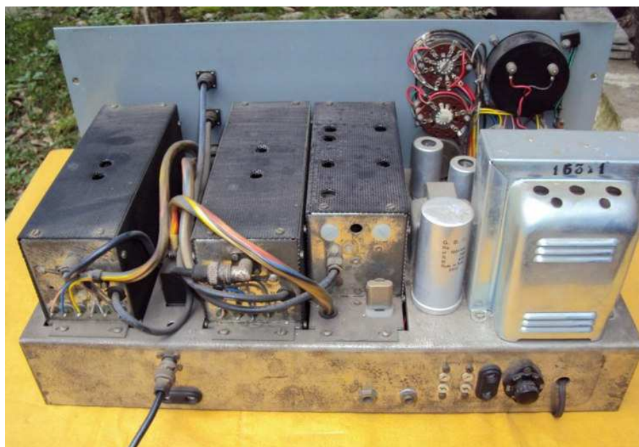
G4/172 prototipo visto da dietro si nota l'alimentatore differente
